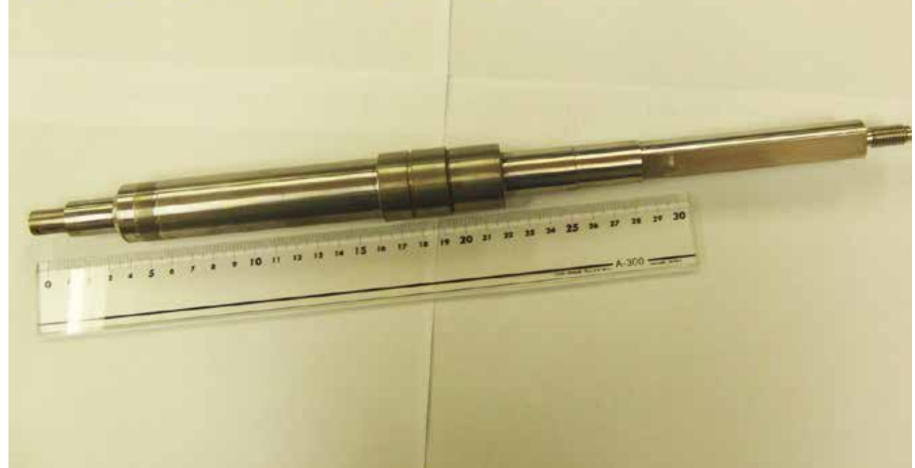
ポンプ用のモーターシャフト(軸) SUS304+S45C圧接
