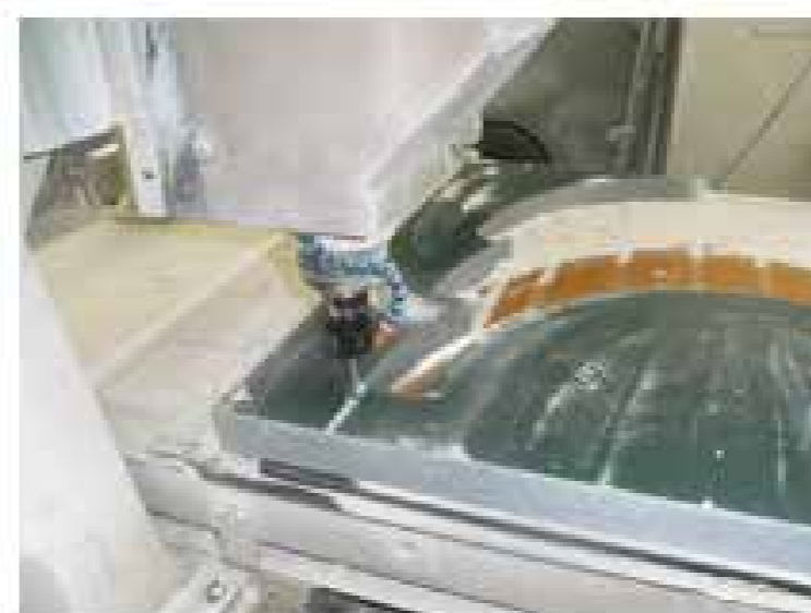
エポキシ材ルーター加工
