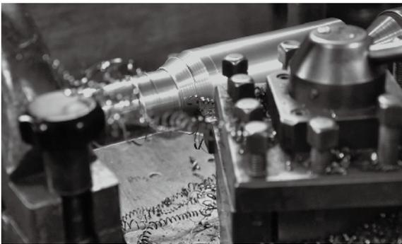
金属やプラスチックを削る工程です。タングステン等の特殊な金属素材の高精度加工に特化した工場もあります。
